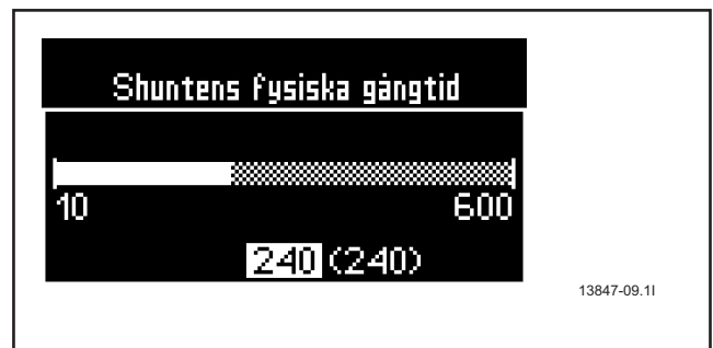
Bild 9 Väg: Meny\Pool\Poolshunt\Shuntens gångtid
